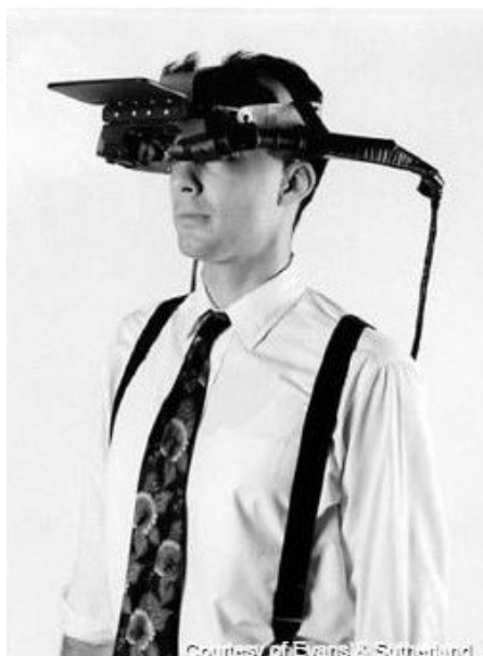
Rys. 3. „Sword of Damocles”. System składał się z dwóch dużych lamp katodowych umieszczonych po bokach głowy użytkownika oraz luster, które wyświetlały obrazy przed oczami [9].
